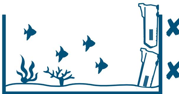
El filtro no debe estar fuera del agua y no debe estar en contacto con ningún sustrato.
